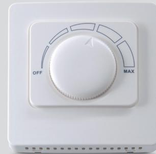
Der Regler dient zur automatischen Regelung der Temperatur. Ein angeschlossener NTC-Fühler misst die Temperatur am Montageort, z. B. im Heizestrich oder in der beheizten Wandkonstruktion und schaltet abhängig vom eingestellten Temperaturwert die Heizleistung ein oder aus. Die gewünschte Temperatur kann zwischen +5 °C und +50 °C eingestellt werden.
