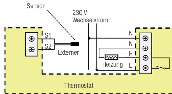
Bei Heizmatten mit Schutzumflechtung muss diese mit dem Schutzleiter des Netzes (PE / Leiterfarbe grün- gelb) verbunden werden. An den beiden Klemmen (S1 und S2) wird der externe Temperaturfühler angeschlossen.
