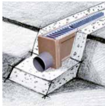
Anschluss mittels eines waagerechten Auslaufes
