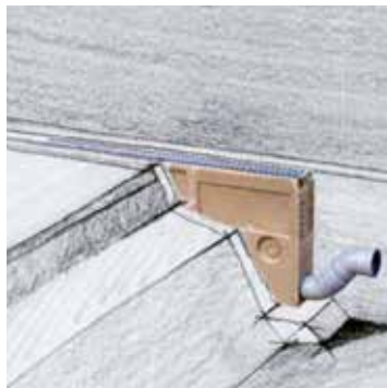
Anschluss mittels eines Einlaufkastens
