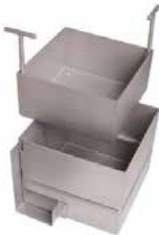
Die Revisionskästen (mit seitlichem Ablauf oder Bodenablauf) bzw. die Spülkästen (ohne Ablauf) werden entsprechend der bestellten Abmessungen der Schlitzrinnen gefertigt. Die Kästen müssen wie die Rinne entsprechend gebettet werden. Die Materialstärke beträgt 1,5 mm.
